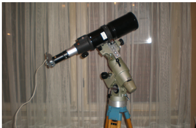
Slika 1: Celestron EQ80 na vixen GP nastavitvi s spletno kamero Philips Toucam Pro II.
